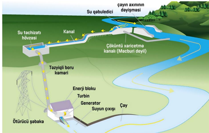
Şəkil 5. Axar su elektrik stansiyasının quruluşu.
