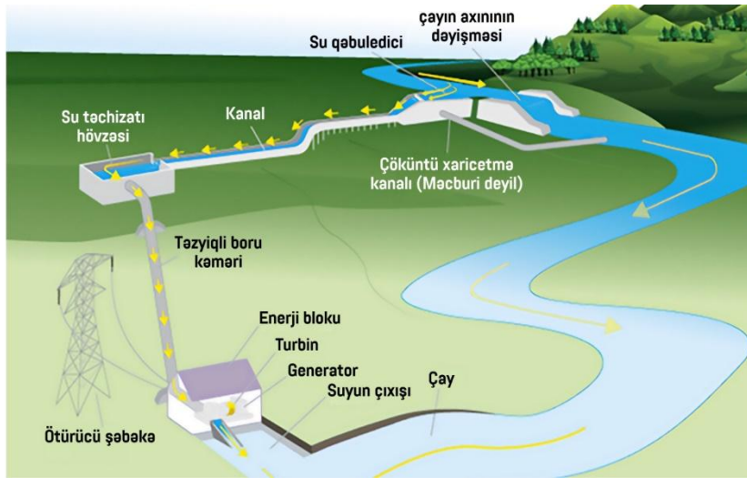
Şəkil 5. Axar su elektrik stansiyasının quruluşu.
